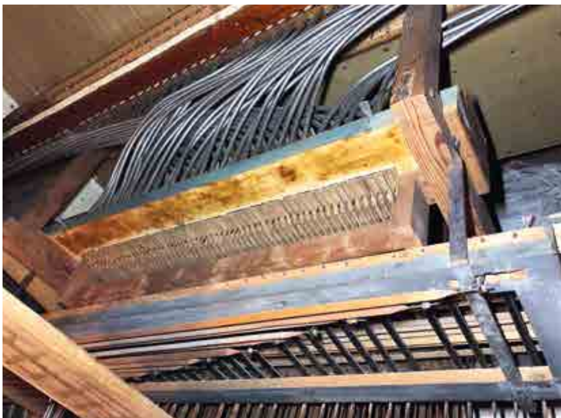
Fig. 4. Pneumatica trasmissiva di comando.
