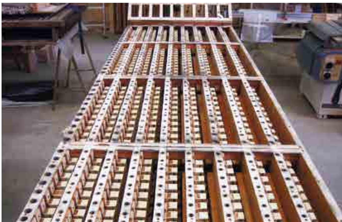
Fig. 4. Apertura del somiere dell'Organo Espressivo.
