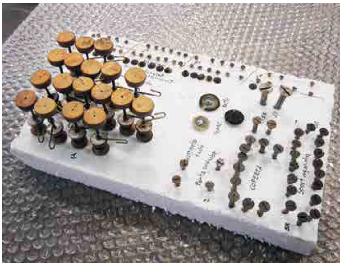
Fig. 7. Catalogazione e conservazione scrupolosa di tutte le viti e delle valvole.
